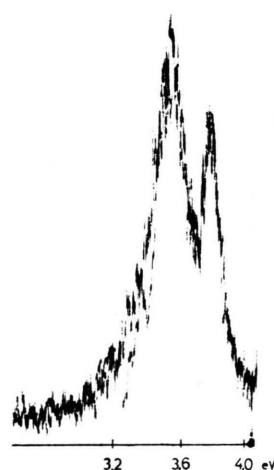
Abb. 1. Energieverlustspektrum einer 600 Å dicken Silberfolie zwischen 2,5 und 4 eV bei T = 7 °K. Der linke Verlust stellt den Oberflächen-, der rechte den Volumenverlust dar.
